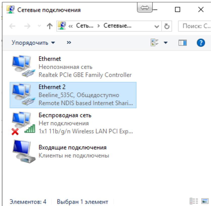
Нужно выделить тот адаптер, который подключен к Интернет в данный момент. В нашем примере это Ethernet\_2, Beeline\_535C. Собственно, это USB модем, включённый в компьютер.
